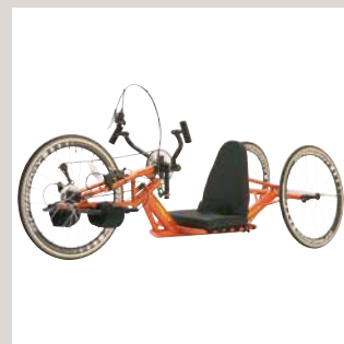
De Invacare Top End Force G heeft een rughoekverstelling van 55 tot 90°.
