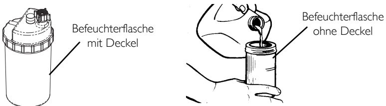
ABBILDUNG 6.3 Auffüllen des Befeuchters
