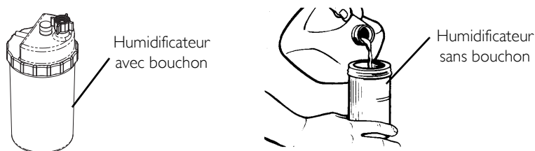
FIGURE 6.3 Remplissage de l'humidificateur
