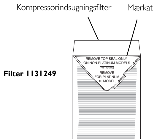
FIGUR 6.3 Udskiftning af kompressorens indsuigningsfilter
