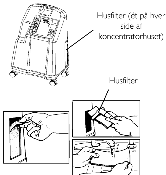
FIGUR 6.1 Rengøring af husets filter.
