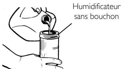
FIGURE 6.1 Remplissage de l'humidificateur
