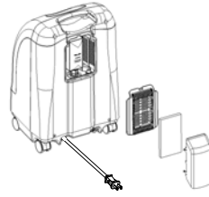
FIGURE 7.1 Czyszczenie filtra obudowy
