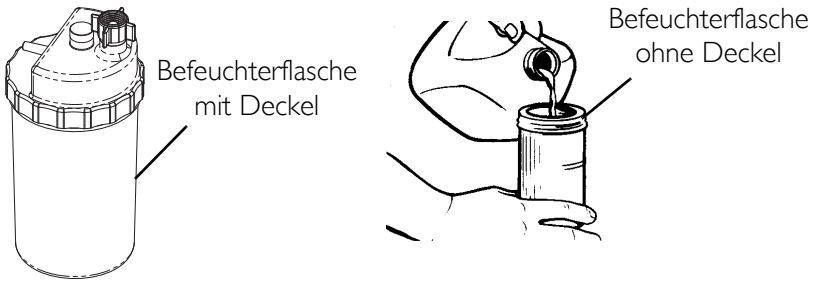
ABBILDUNG 6.1 Auffüllen des Befeuchters
