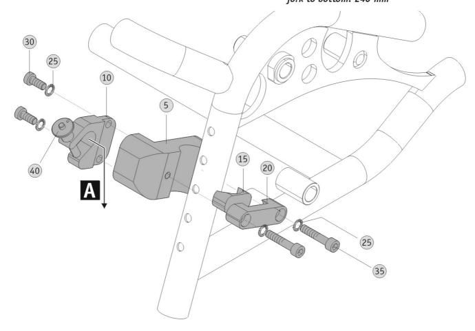
Das Anbringen von Kippstützen an das viaplus oder den Rollstuhl wird bei Fahrten in der Ebene aus Gründen der Sicherheit dringend empfohlen. Bei Fahrten an Steigungen über 8% ist die Verwendung von paarweisen Kippstützen zwingend vorgeschrieben. It is strongly recommended that anti-tippers are mounted to your viaplus or wheelchair for drives on flat surfaces! The use of paired anti-tippers is mandatory on drives on uphill slopes over 8%.
