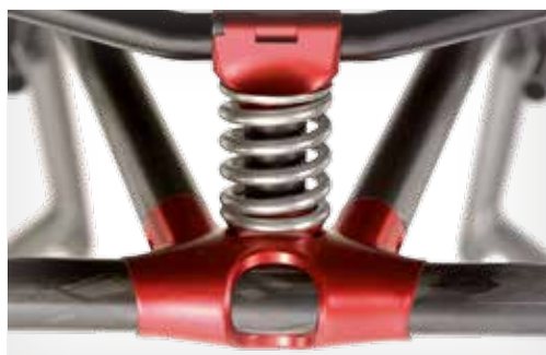
Low Impact System: een geïntegreerde schokdemper
