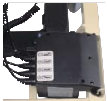
Markering van electronica en kabels t.b.v. eenvoudige montage
