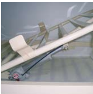
Rugsteun met noodfunctie voor zakken bij hartmassage. Relève-buste avec descente d'urgence en cas de massage cardiaque.
