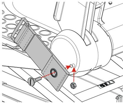
1. Mit Hilfe der Bohrschablone auf der Rückseite eine Bohrung  $\varnothing$  6,5 mm durch die äußere Wandung herstellen.
