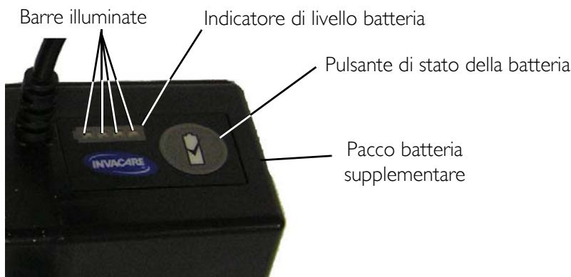
FIGURA 6.6 Prolungamento della vita della batteria
