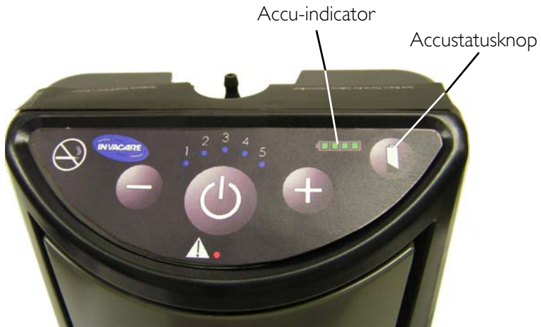
FIGUUR 6.2 Controleren van vermogen van de interne accu
