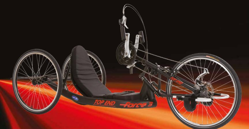
Le handbike Invacare Top End Force-3 se distingue par son châssis enveloppant, son frein à disque à l'avant, ses 27 vitesses, son dérailleur supérieur piloté par câble et ses roues 26"-559 tous chemins. Cette taille de roue permet de trouver un pneu de remplacement très facilement. Disponible en stock et prêt à être livré en 2 largeurs d'assise.
