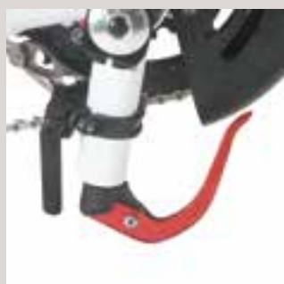
Position du second frein sous le boîtier de pédalier sur Top End Force RX .
