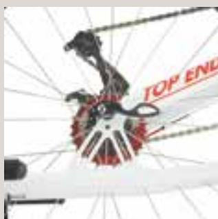
Patte de fixation de fourche redesignée pour un meilleur aérodynamisme, plus de rigidité et de légèreté sur Top End Force RX .
