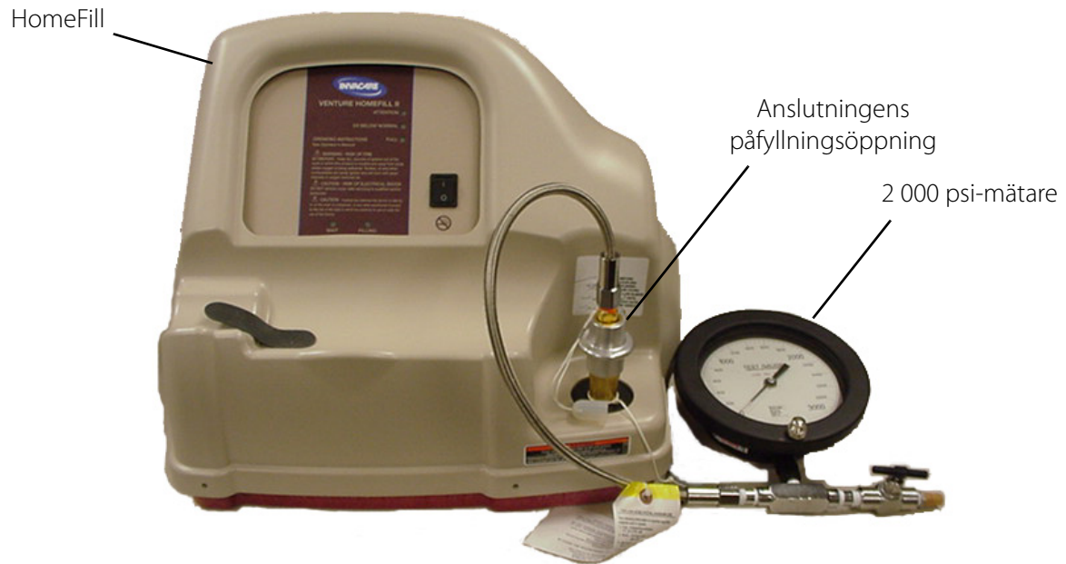
BILD 13.3 Avstängningstest av HomeFill 2000 psi-brytare/kretskort
