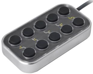
C'est une alternative facile pour l'utilisation des vérins et il peut être monté à trois emplacements : entre la manchette et le manipulateur, en bout de manchette opposée au manipulateur ou à l'arrière du fauteuil pour la tierce-personne.
