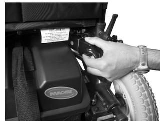
3. Rimuovere i connettori del cavo della batteria da entrambi i lati (la figura mostra solo il lato destro).
