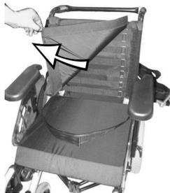
Rimuovere il cuscino dello schienale (fissato con fascette in velcro) tirandolo verso l'alto per accedere alle cinghie di regolazione.
