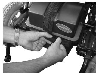
2. Aprire la fibbia della cinghia di fissaggio della batteria.
