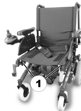
Sotto il sedile sono presenti due blocchi (1) situati a destra e a sinistra che vanno sbloccati al fine di piegare la carrozzina.
