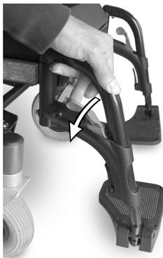
1. Premere la leva di sbloccaggio verso l'interno o l'esterno. Il portapedana è sbloccato.
