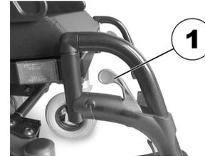
La piccola leva di sbloccaggio si trova nella parte superiore del portapedana (1). Se il portapedana è sbloccato, esso può ruotare all'interno o all'esterno, nonché tolto completamente.
