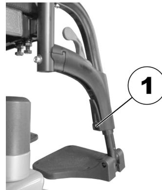
1. Allentare la vite (1) con la chiave per viti ad esagono incassato, ma non svitare completamente.
