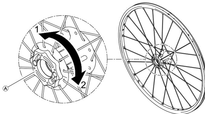
1. Pour actionner le frein sur moyeu, tournez la couronne de frein **A** dans le sens 1 jusqu'en butée.
