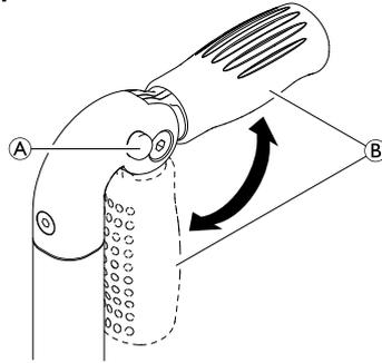
1. Enfoncez complètement le bouton (A) tout en repliant la poignée de poussée (B) jusqu'à ce qu'un déclic de mise en place se fasse entendre.
