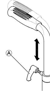
1. Pour régler la hauteur des poignées de poussée, desserrez le boulon (A), portez la poignée dans la position souhaitée, puis resserrez le boulon.
