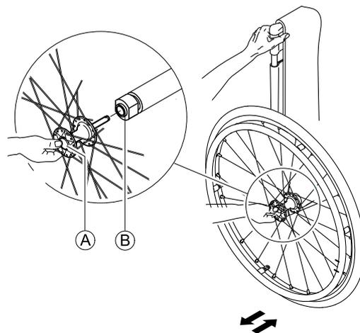
**Démontage des roues arrière**
