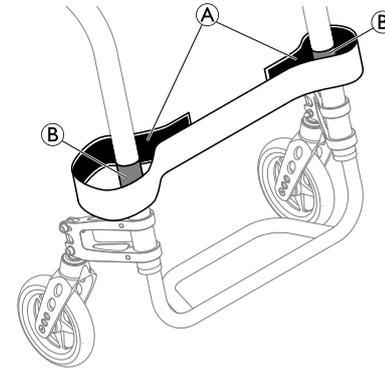
1. Fixez et ajustez l'appui-mollets **A** autour des bandes de fixation à crochets et à boucles **B** sur les deux pièces du châssis.
