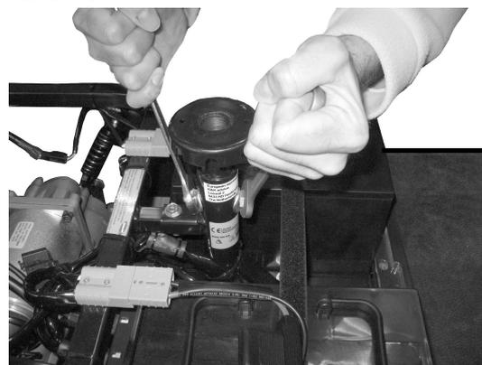
Retirez le boulon de fixation, l'écrou et les rondelles du tube de support d'assise.
