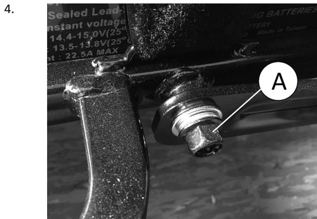
Desserrez et retirez la vis **A** qui fixe le bras oscillant au châssis sur les côtés gauche et droit du véhicule électrique.
