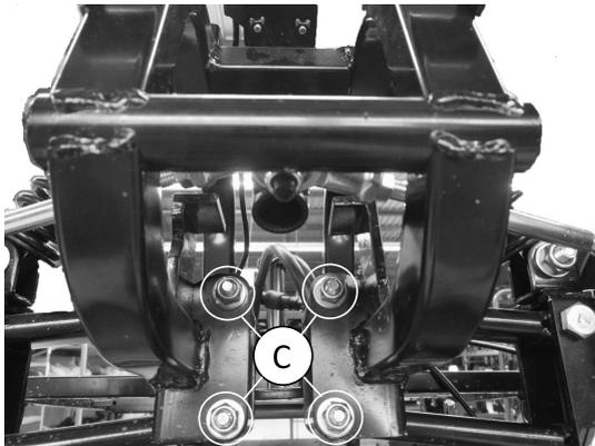
Desserrez les quatre vis **C** qui fixent les traverses au châssis.
