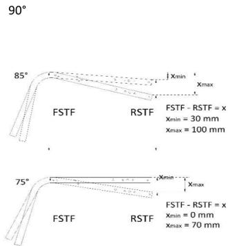
Tableau 1 : Position palette monobloc selon angle de châssis et taille des roues avant
