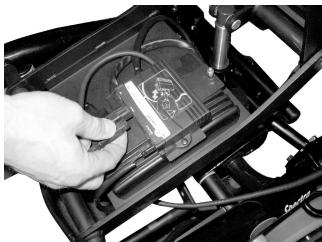
Iskopčajte kabel priključka daljinskog upravljača iz elektroničkog sustava.
