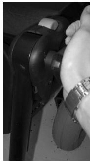
Pritisnite kotačić da biste otpustili mehanizam za blokadu.
