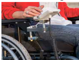
Fäste för manöverbox E-fix i armstöd Montering av fäste i arm- stödet istället för i ramen
