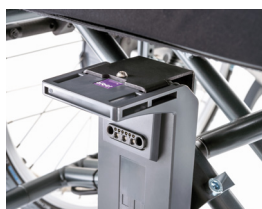
Batteribox fast hylla Batterihållare monteras med klämmor direkt i chassit istället för med velcrobånd
