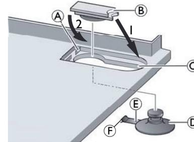
1. Den roten Saugerdeckel **B** von unten aus der Schlüsselbohrung **C** der Grundplatte drücken.
