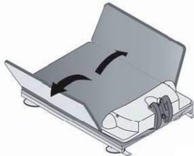
2. Die Seitenklappen am Sitz nach außen klappen.
