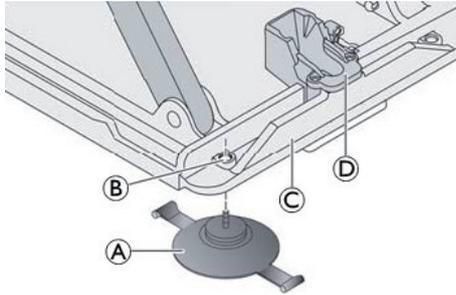
1. Den Sauger (A) von unten in die dafür vorgesehene Gewindebuchse (B) einschrauben.
