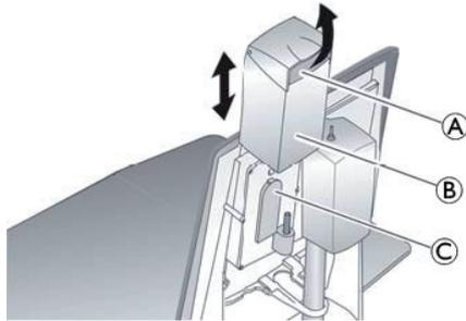
6. Den geladenen Akku ⑧ am Haltegriff ⑤ festhalten und von oben in die Föhrung ③ an der Rückenlehne einföhren.
