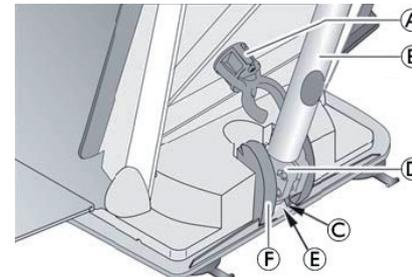
Dabei greifen die Zapfen am Klemmring ④ in die Führungen ⑥ an der Sitzplatte ein.
