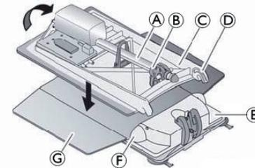
3. Die Rückenlehne **C** (ohne Akku) so auf den Sitz legen, dass die Schlitze **D** in der Rückenlehne in die Scharniere **F** der Sitzplatte **E** eingreifen.
