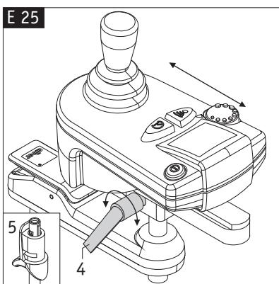
**!** Éteignez toujours l'appareil de commande avant le montage ou le démontage ! Ceci empêche un déplacement incontrôlé de votre fauteuil roulant, par exemple par contact accidentel avec le joystick.
