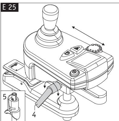
**!** Schalten Sie das Bediengerät vor dem Anbringen bzw. Abnehmen immer aus! Sie vermeiden dadurch ein ungewolltes Wegrollen Ihres Rollstuhls, beispielsweise verursacht durch eine unbeabsichtigte Berührung des Joysticks.
