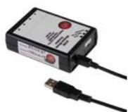
O emulador de rato dá acesso sem fios a computadores e dispositivos de comunicação, que podem ser operados através de 3, 4 ou 5 sensores/ switches. O emulador de rato tem a capacidade de controlar a velocidade do movimento do rato e, tempos de resposta.
