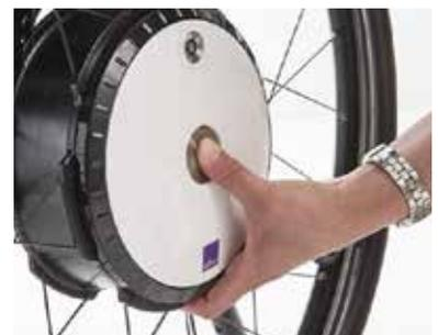
La roue peut être retirée en appuyant sur le bouton d'axe à démontage rapide, servant également à extraire la roue. Un parfait exemple de conception multifonctionnelle.
