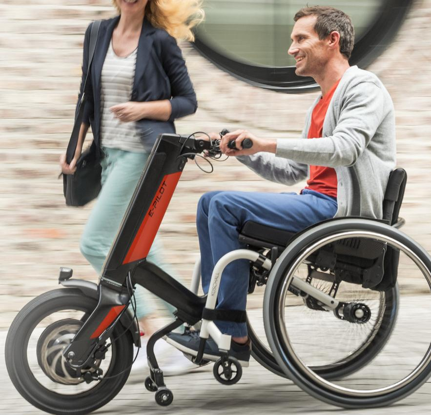
Avec le nouveau frein Tetra, Alber propose maintenant une option de commande pour le e-pilot, qui a été spécialement développée pour les personnes tétraplégiques ayant une fonction limitée des doigts et des mains. La sangle et l'ergonomie du repose-main l'empêchent de glisser et assurent ainsi une sécurité nettement accrue lors du freinage.
