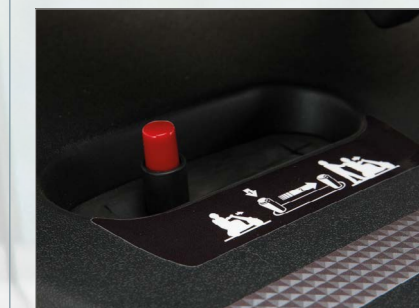
2-stegs frikoppling, för att förhindra frirullning
