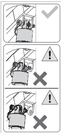
Asegúrese de que el pistón del mástil esté fijado correctamente al brazo.
