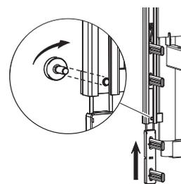
Desaperte o parafuso na parte inferior das guias numa das extremidades da cama e empurre o deslizador até meio para dentro da guia até encaixar com um clique.
