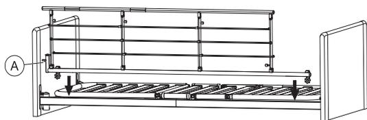
Coloque a guarda lateral sobre o chassis superior com o sistema de desengate **A** na cabeceira da cama.
