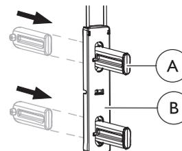
Empurre a lingueta **A** da parte posterior pelo deslizador **B** e certifique-se de que encaixa, o que é assinalado por um clique.
