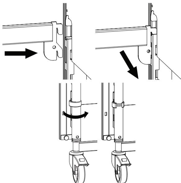
Volte a instalar a extremidade dos pés da cama e fixe-a aos suportes.
