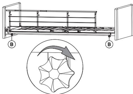
Aperte os parafusos de aperto manual **B** para instalar a guarda lateral no chassis superior. Certifique-se de que está estável e bem fixada.
