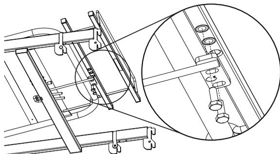
Fixe o gancho de extensão à plataforma de extensão, utilizando os orifícios roscados disponíveis.
