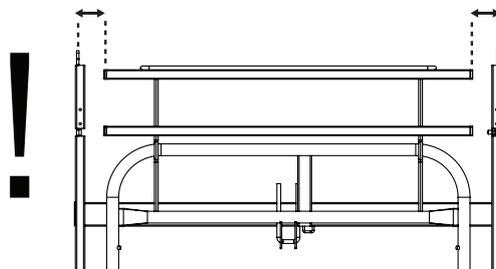
Se a cama tiver uma pega de colchão montada na secção das pernas (ver 4.6 Ajustar a secção das pernas, página 18), a mesma deve ser rodada para não interferir com o colchão.
