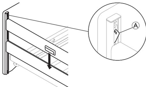
Pressione o fecho do sistema de deslizamento (A) numa extremidade da cama e baixe a guarda lateral até à posição mais baixa.
