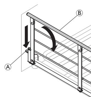
1. **Para cima:** Eleve e puxe a barra superior (B) da guarda lateral para a extremidade com o mecanismo de bloqueio (botão de desengate) (A). Certifique-se de que está fixa.
