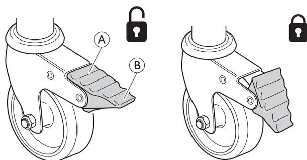
**Bloquear o travão** - Pise a parte exterior (B) do pedal do travão
