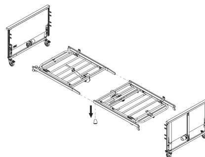
2. Empurre os encaixes na metade superior do estrado para dentro dos tubos laterais na metade inferior do estrado.
