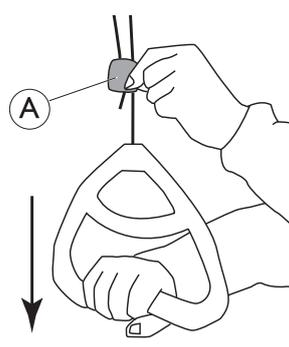
1. Mantenha o cabo do lado de fora enquanto faz deslizar o fecho do cabo de plástico (A) para cima ou para baixo até o manípulo atingir a altura preferida.
