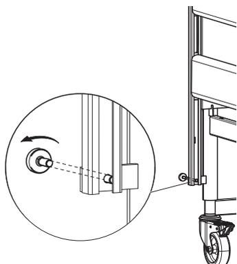
Aperte novamente os parafusos por baixo da barra inferior da guarda lateral, em cada canto das extremidades da cama.
