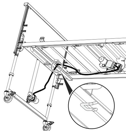
11. Coloque a extremidade da parte espiralada do cabo do motor de subida/descida no gancho da extremidade da cama.
