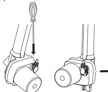
5. Desligue o cabo do motor do encosto.
