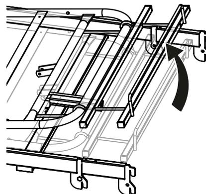
Levante a secção das pernas para facilitar a montagem.
