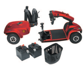
Demontage in vijf delen
