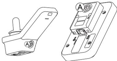
1. 배터리 충전기를 리모컨의 충전기 소켓 ①에 꽂으십시오.
