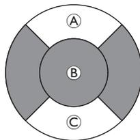
조이스틱이 구성 가능한 임계값 ⑥를 지나 전방 ① 또는 후방 ③ 사분면으로 편향되어 추가적인 편향 없이 미리 설정된 최대 속도에 도달하면 속도가 활성화됩니다. 조이스틱 스위치 임계값은 제품업체가 설정할 수 있습니다. 조이스틱을 중립 위치로 다시 옮기면 휠체어는 감속하여 정지합니다.
