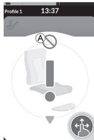
구동 전자 장치에는 좌석 틸팅 또는 리클라이닝이 특정 지점 이상으로 조절될 경우 좌석 리프터가 특정 지점 이상으로 상승하는 것을 방지하는 센서가 장착되어 있습니다. 구동 전자 장치는 자동으로 멈추고, 좌석 카드에 회색 느낌표가 표시되며, 연장이 금지됩니다 A.
