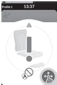
최대 틸팅 제한 스위치는 좌석 리프터가 특정 지점 이상으로 상승할 경우 좌석 틸팅 또는 리클라이닝이 미리 설정된 최대 각도를 넘어 연장되지 않도록 방지하는 기능입니다. 구동 전자 장치는 자동으로 멈추고, 좌석 카드에 회색 느낌표가 표시되며, 후방으로 틸팅 또는 리클라이닝하는 것이 금지됩니다 A.
