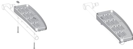
1. À l'aide du matériel de fixation fourni, installez le corps de la manchette d'accoudoir moulé sur le tube de l'accoudoir dans l'orientation de montage (reportez-vous à l'illustration ci-dessus) et la position de la manchette d'accoudoir (reportez-vous aux réglages de largeur et de profondeur ci-dessous) pré-déterminées.
