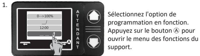
Sélectionnez l'option de programmation en fonction. Appuyez sur le bouton **A** pour ouvrir le menu des fonctions du support.
