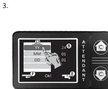
3. Appuyez sur la fonction de programmation souhaitée pour modifier la valeur **B** en appuyant sur les flèches haut ou bas **C**. Appuyez sur le bouton **E** pour effectuer une sauvegarde après chaque réglage. Appuyez sur la flèche **D** pour ouvrir le menu de l'heure. La sauvegarde réussie est affichée par « Ok ! ». Appuyez sur le bouton **F** pour revenir à l'écran d'accueil.
