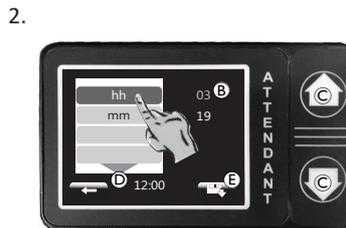
2. Appuyez sur la fonction de programmation souhaitée pour modifier la valeur **B** en appuyant sur les flèches haut ou bas **C**. Appuyez sur le bouton **E** pour effectuer une sauvegarde après chaque réglage. Appuyez sur la flèche **D** pour ouvrir le menu de la date.
