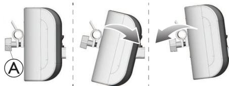
Desserrez les vis ailées **A** et faites pivoter la genouillère autour de la traverse jusqu'à la position souhaitée.
