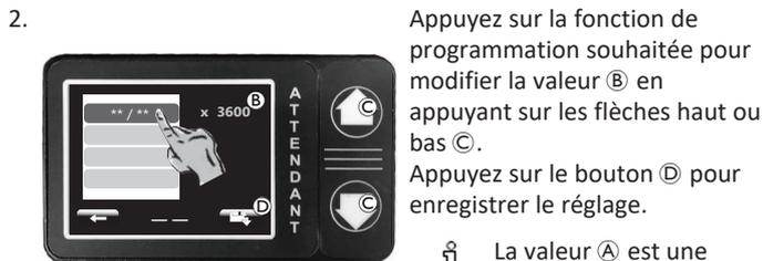
Appuyez sur la fonction de programmation souhaitée pour modifier la valeur **B** en appuyant sur les flèches haut ou bas **C**. Appuyez sur le bouton **D** pour enregistrer le réglage.
