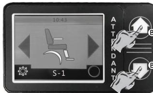
Si la fonction d'assise souhaitée s'affiche, appuyez sur les flèches haut ou bas Ⓑ et maintenez-les enfoncées pour actionner la fonction de positionnement électrique jusqu'à la position souhaitée.
