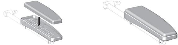
1. Fixez les manchette d'accoudoir modulaires à l'intérieur du corps des manchettes d'accoudoir moulées au moyen de sangles à crochets et à boucles (non représentées).
