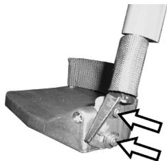
1. Торцевым шестигранным ключом ослабьте оба фиксирующих винта панели для ног.
