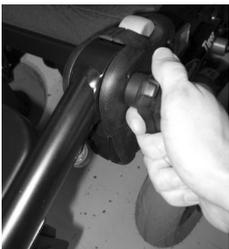
Затяните фиксатор, повернув ее по часовой стрелке.
