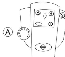
La vitesse maximale du fauteuil roulant peut être réglée par l'utilisateur en fonction de ses exigences personnelles et des conditions de son parcours. La vitesse maximale actuellement établie apparaît sur l'écran d'affichage de la vitesse **A** du fauteuil roulant et peut également être prédéfinie dans cet écran. Vous pouvez effectuer d'autres
