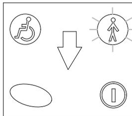
La LED de contrôle du fauteuil roulant par une tierce-personne est verte lorsque l'IDC est en charge. Si une anomalie est détectée par le système LiNX, la LED de contrôle du fauteuil roulant par une tierce-personne clignote en vert.
