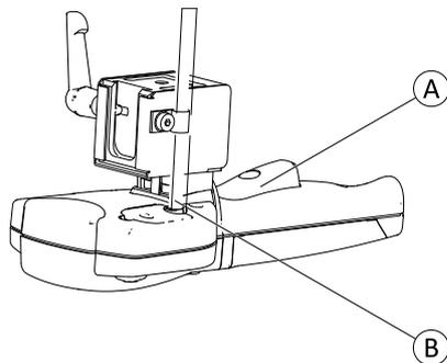
A Levier de déclenchement pour la conduite/l'arrêt d'urgence
