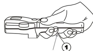
Si le fauteuil roulant doit être arrêté immédiatement en raison d'une situation dangereuse, tirez fermement sur le levier de déclenchement (1) jusqu'en butée. Cette action entraîne un arrêt forcé immédiat. Lorsque vous relâchez le levier de déclenchement (1), et que la LED de la tierce-personne cesse de clignoter, vous pouvez recommencer immédiatement à conduire le fauteuil roulant.
