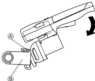
1. Placez le support de l'adaptateur **A** sur l'adaptateur KLiCKfix **B**.
