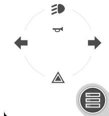
Fig. 3-10 Exempel på ett fyrkvadrant (4Q) supportpanel
