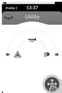
Fig. 3-9 Ejemplo de una tarjeta de utilidad de navegación de tres cuadrantes (3Q)
