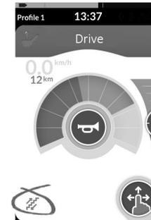
Su proveedor puede asignar cada función de conducción a un modo de conducción acoplada. Existen seis modos de conducción acoplada, que se indican en la parte inferior izquierda de la tarjeta de conducción con los símbolos que se muestran en la tabla siguiente.
