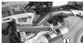
Desserrez et retirez la suspension moteur.
