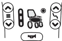
Le système électronique de commande est équipé d'un interrupteur de verrouillage d'élévation de l'assise qui empêche le dispositif de levage de s'élever au-delà d'un certain point lorsque l'inclinaison du siège ou l'angle du dossier est réglé(e) au-dessus d'un certain niveau. Le système électronique de commande s'arrête automatiquement dès que le symbole du dispositif de levage commence à clignoter.
