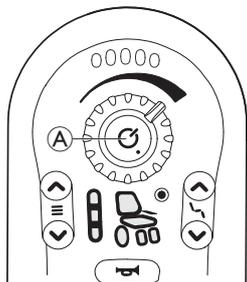
1. Appuyez sur le bouton MARCHÉ/ARRÊT (A) pendant plus de quatre secondes lorsque le manipulateur est sous tension.
