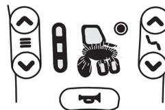
La réduction de vitesse s'affiche dans l'écran d'état. Si le dispositif de levage est élevé au-dessus d'un certain point, le symbole du dispositif de levage et le symbole de conduite commencent à clignoter. Ces deux symboles continuent de clignoter pendant la conduite afin d'indiquer la réduction de vitesse et ce jusqu'à ce que la fonction de réduction de la vitesse soit à nouveau désactivée.
