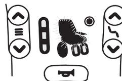
L'interrupteur de fin de course de basculement maximum est une fonction qui permet d'éviter que l'angle du dossier n'aille au-delà d'un angle prédéfini maximum, lorsque le dispositif de levage est élevé au-delà d'un certain point. Le système électronique de commande s'arrête automatiquement et le symbole d'inclinaison du siège ou du dossier commence à clignoter.
