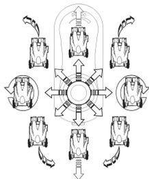
Lorsque le joystick est dévié par rapport à la position centrale (neutre), le fauteuil roulant se déplace dans la direction du mouvement du joystick.
