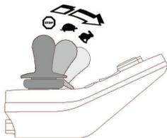
La vitesse du fauteuil roulant est proportionnelle à la déviation du joystick. Par conséquent, plus le joystick est dévié par rapport à la position neutre, plus le fauteuil roulant se déplace rapidement.
