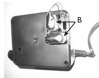
**i** Er is een ruimte in de voedingskast voor twee palen 9V (B, niet inbegrepen). Beide accu's maken een afdaling in het geval van stroomuitval (moet worden vervangen na elk gebruik).
