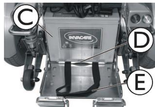
Tirare in avanti le batterie **C** e il relativo supporto **D** tramite la cinghia **E** fino al fine corsa.
