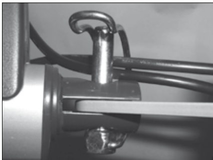
Leitungsführung des Motors für das Beinteil und des Motors für das Fußende durch den Rohrsplint des Rückenlehnenmotors.
