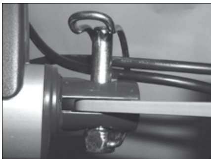
Bedrading van het beengedeelte motor en voetend door rugsteun motor bevestigingspin.
