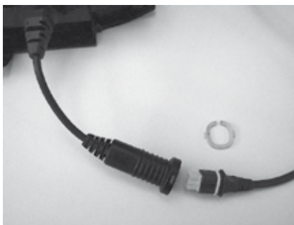
(Nas Medley com fornecimento de energia em separado) conectar o cabo de fornecimento de energia ao cabo da unidade de controlo e fixe a conexão com o bloqueador de cabos.
