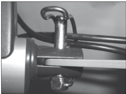
Cablaggio dei cavi di alimentazione del motore pediera e del motore alzagambe attraverso il sistema di aggancio del motore alzatesta.
