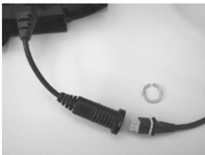
(Sul Medley con l'alimentazione esterna) unite il cavo di alimentazione all'unità di controllo e assicurate la connessione con il ancio di sicurezza.
