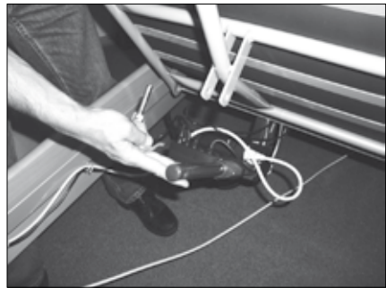
2) Den Splint für den Rückenteilmotor ziehen.
