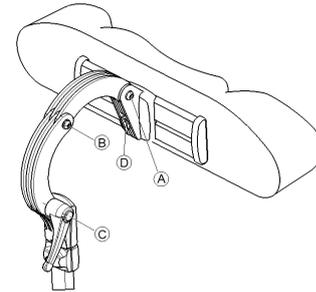
1. Aperte os parafusos (A), (B) ou a alavanca de fixação (C).
