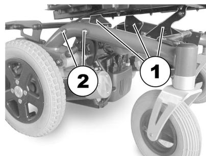
A imagem acima ilustra a posição das placas perfuradas (1) e os parafusos de fixação da placa de suporte (2) para ajustar a altura e o ângulo do assento.
