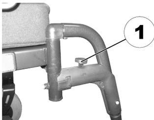
O pequeno botão de desbloqueio encontra-se na secção superior do apoio de pernas (1). Se o apoio de pernas for desbloqueado pode ser rodado para o interior ou exterior para permitir que se sente ou pode ser removido completamente.
