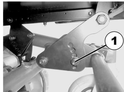
A imagem acima ilustra as placas perfuradas dianteiras. O procedimento é semelhante para as placas perfuradas traseiras. Para além de uma chave Allen de 5 mm, é necessário uma chave de 13 mm para ajustar as placas perfuradas dianteiras.
