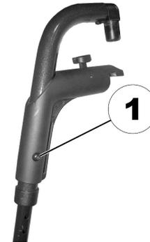
1. Desaperte o parafuso (1) com chave Allen, mas não o remova completamente.
