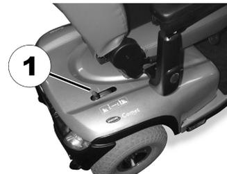
Le levier d'embrayage et de débrayage du moteur se trouve à l'arrière, sur le côté droit.
