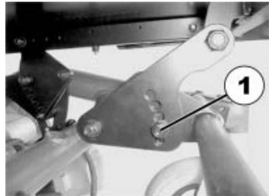
La hauteur et l'angle d'assise peuvent en plus être réglés par l'intermédiaire des tôles de retenue arrière.
