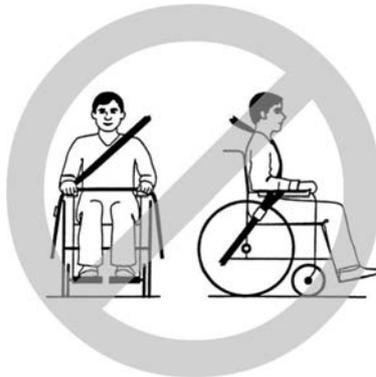
Los cinturones de seguridad no deben mantenerse alejados del cuerpo mediante partes del vehículo eléctrico, como los reposabrazos o las ruedas.
