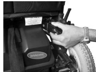
Extraiga las clavijas de conexión del cable de la batería a ambos lados (la imagen solo muestra el lado derecho).
