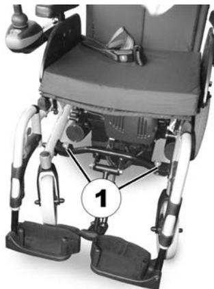
1. Pulse los botones de desbloqueo y tire de los ejes de desmontaje rápido (1) para extraerlos de los soportes.
