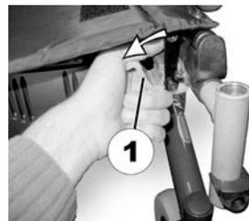
Pulse la palanca de bloqueo (1) hacia dentro y hacia abajo.
