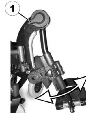
1. Apriete hacia abajo la palanca desbloqueadora (1). Ajuste el reposapiés al ángulo deseado.
