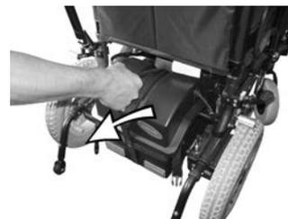
Tire de la caja de la batería trasera hacia la parte posterior.
