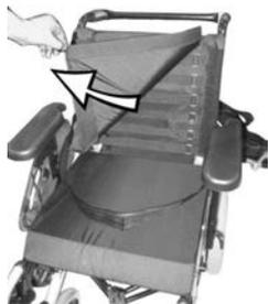
Quite el cojín del respaldo (fijado con cierres de velcro) tirando de él hacia arriba y quítelo para acceder a los cierres de ajuste.
