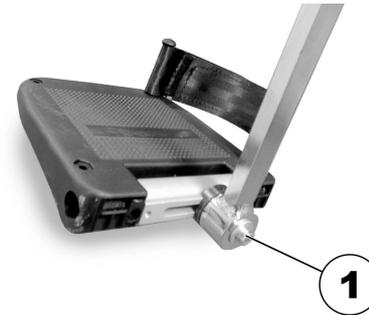
1. Desapertar o parafuso de fixação do patim (1) com a chave Allen.
