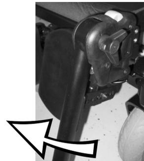
Rodar o apoio de pernas para cima para chegar ao amortecedor de borracha.
