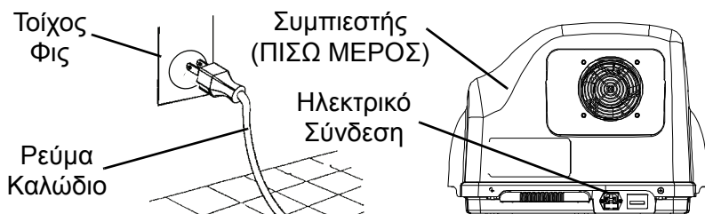
ΕΙΚΟΝΑ 2.2 Εγκατάσταση του Καλωδίου Ρεύματος
